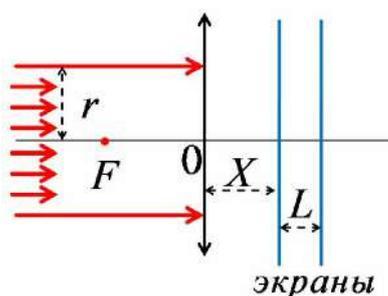
На собирающую линзу с фокусным расстоянием  $F=33$  см параллельно главной оптической оси падает цилиндрический пучок света радиусом  $r=12.9$  см. Диаметр пучка меньше диаметра линзы. За линзой параллельно её плоскости расположены два полупрозрачных экрана на некотором расстоянии друг от друга. Светлые круги на экранах одинаковы по размеру и имеют радиус  $R_1=4.2$  см. Определите:
