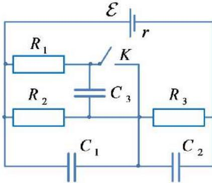
В электрической схеме, показанной на рисунке, ЭДС источника=196 В, его внутреннее сопротивление  $r=4.7$  Ом, сопротивления резисторов -  $R_1=11$  Ом,  $R_2=26$  Ом,  $R_3=49$  Ом. Ёмкости конденсаторов -  $C_1=42$  мкФ,  $C_2=72$  мкФ,  $C_3=22$  мкФ.
