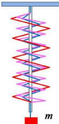
Три пружины различной жёсткости и длины ( $k_1=492 \text{ Н/м}$ ,  $L_1=34.7 \text{ см}$ ,  $k_2=437 \text{ Н/м}$ ,  $L_2=47.7 \text{ см}$ ,  $k_3=525 \text{ Н/м}$ ,  $L_3=56.8 \text{ см}$ ) соединили и надели на жёсткий стержень, чтобы конструкция не изгибалась. Массой пружин можно пренебречь.
