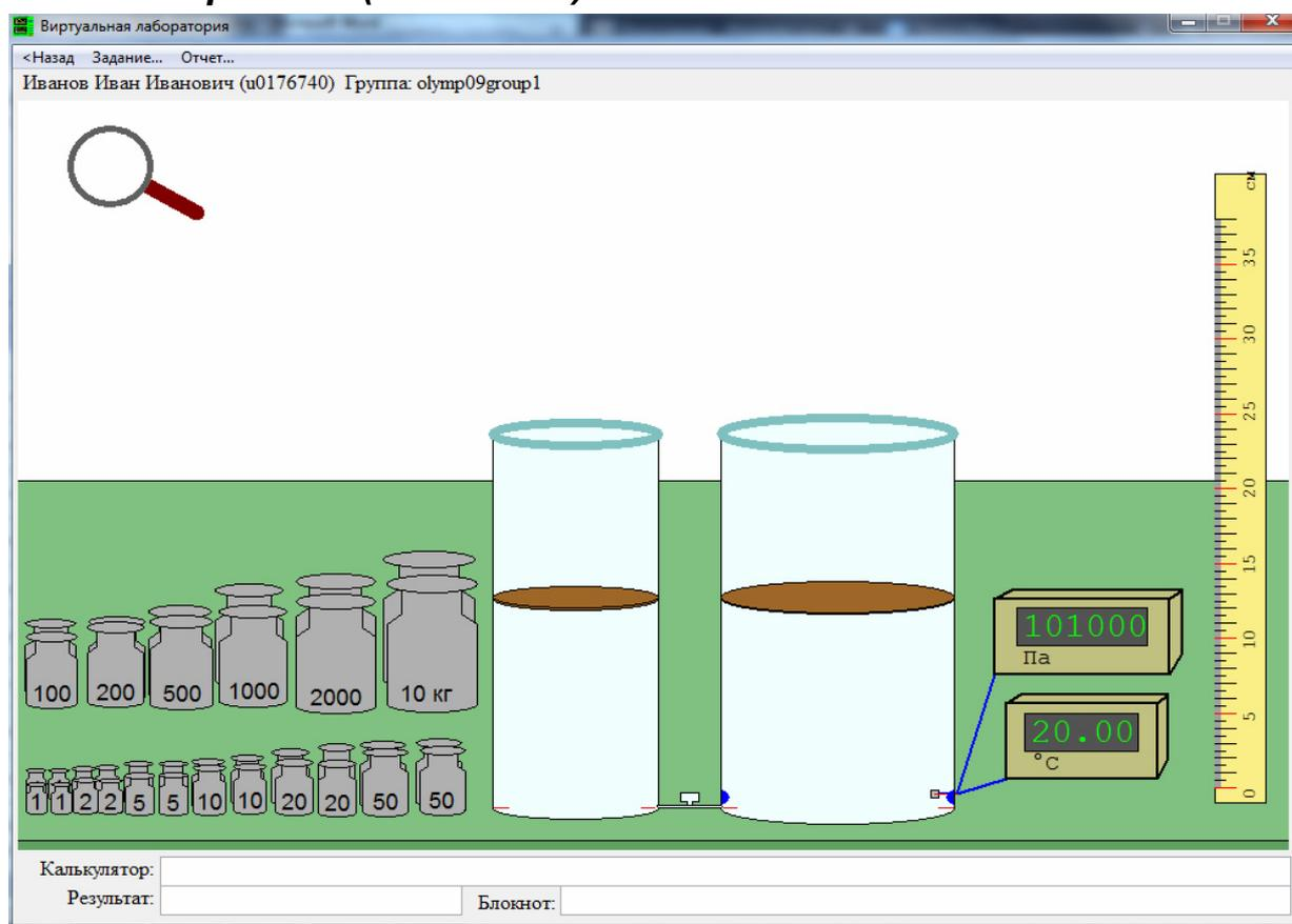
В цилиндрических сосудах с невесомыми поршнями содержится некоторый газ, температура которого поддерживается постоянной. Соединительную трубку между сосудами можно перекрывать и открывать.
