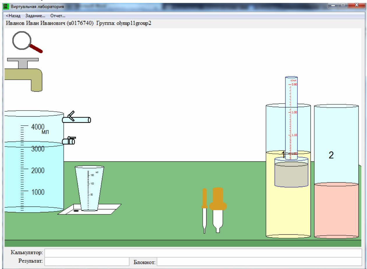
Имеются два стакана с некоторыми жидкостями, а также ареометр (прибор, позволяющий измерять плотность жидкостей) и другие элементы лаборатории. Большие стаканы закреплены, и их передвигать нельзя. Можно наливать жидкость в стаканы с помощью пипетки или (в маленький мерный стакан) из крана. Кран, из которого течёт вода, включается/выключается щелчком по его ручке. Определите:
