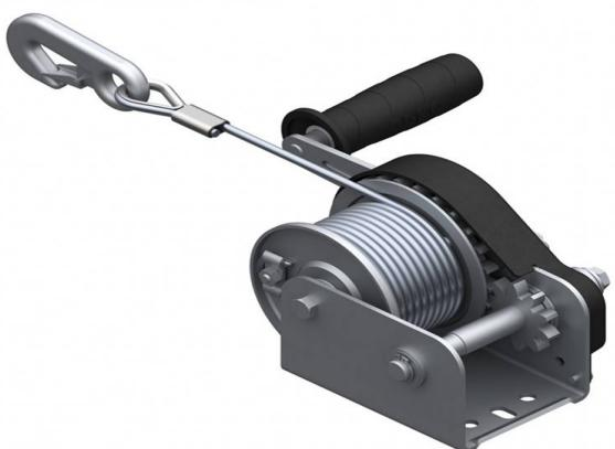
На рисунке показана конструкция ручной лебёдки. Рабочий вращает рукоятку длиной  $L=43$  см, на одном валу с ней жёстко закреплено маленькое зубчатое колесо радиусом  $R_1=3$  см. Посредством зубчатой передачи это колесо приводит во вращение большое колесо радиусом  $R_2=24.7$  см . На одной оси с этим колесом жёстко закреплён вал радиусом  $R_3=7.6$  см, на который наматывается трос лебёдки. Определите:
