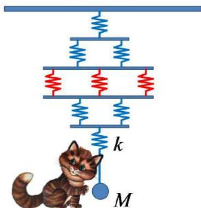
Из девяти одинаковых пружин, жёсткостью  $K=7 \text{ Н/м}$  и маленького мячика массой  $M=52 \text{ г}$  хозяин сделал для Барсика игрушку. Массой соединительных планок можно пренебречь. Определите:
