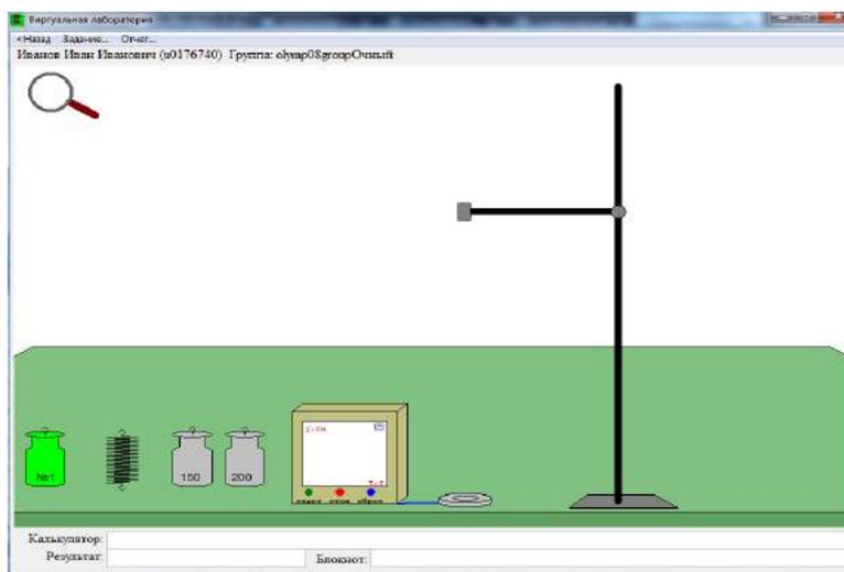
Имеется: гиря неизвестной массы; пружина; штатив, **лапку которого** (зажим) можно перемещать, если в ней ничего не закреплено, и в которой можно закреплять пружину, а к ней - подвешивать гирю; прибор с датчиком координаты. Также имеются гири массой 150 и 200 г.
