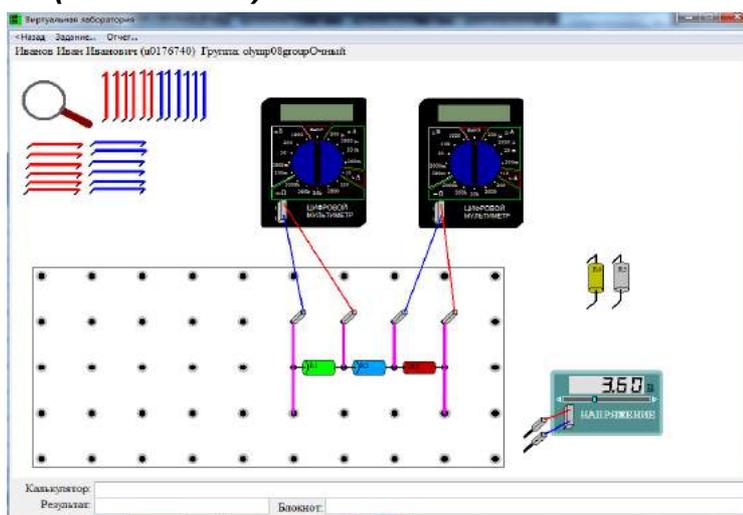
Имеются впаянные в наборную панель резисторы R1, R2, R3 и два мультиметра, резисторы R4 и R5, которые могут быть установлены на неё, а также соединительные провода, источник постоянного напряжения, позволяющий менять на его выходе напряжение. Мультиметры могут работать в режиме (микро/милли)амперметров и
