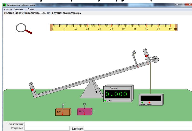
Имеется наклонный рельс с лебёдкой, датчиком натяжения нити и датчиком времени, линейка и два бруска.
