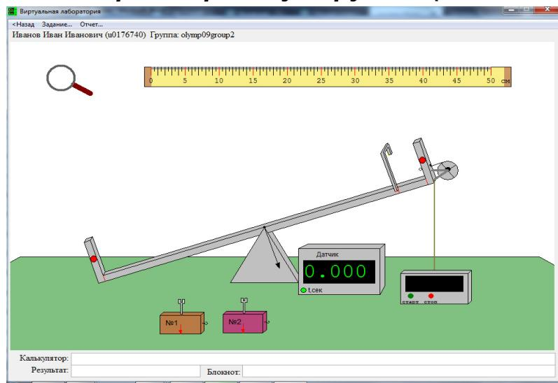
Имеется наклонный рельс с лебёдкой, датчиком натяжения нити и датчиком времени, линейка и два бруска.
