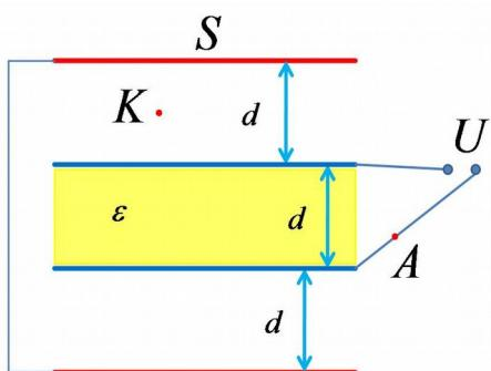
Конденсатор состоит из двух металлических пластин площадью  $S=90$  см<sup>2</sup>, расположенных на расстоянии  $d=0.8$  см. Пространство между обкладками заполнено диэлектриком с проницаемостью  $\epsilon=8$ . Источник поддерживает на конденсаторе постоянное напряжение  $U=670$  В.
