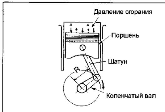
Такие двигатели развивают большие обороты коленчатого вала, что дает возможность получения высокой мощности.
