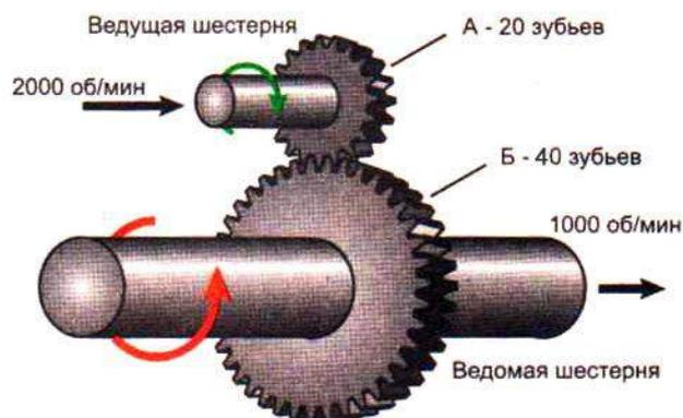
Если привод состоит из нескольких передач, то общее передаточное число определяется, как:  $i_{пр} = i_1 \cdot i_2 \cdot \dots \cdot i_n$ ;
