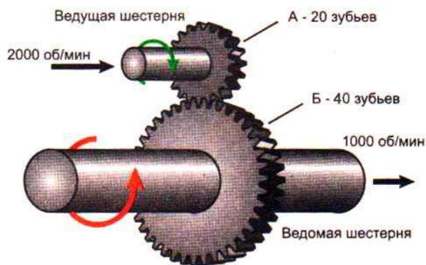
Если привод состоит из нескольких передач, то общее передаточное число определяется, как:
