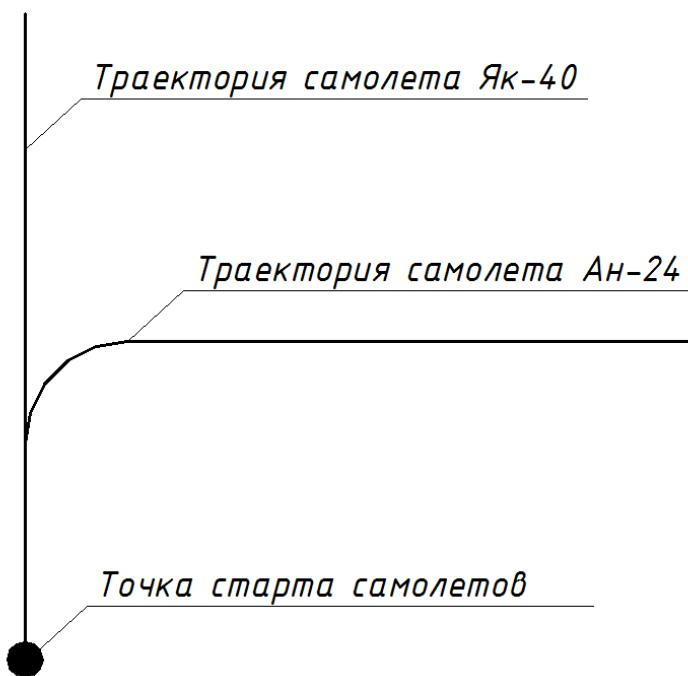
**Указания:** Движения самолетов при наборе скорости считать равноускоренными. Полеты рассматривать в горизонтальной плоскости.
