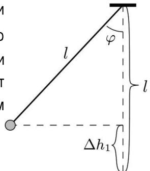
Изменение высоты лампочки при отклонении на угол  $\varphi$  равно  $\Delta h_1 = l - l\cos\varphi = l(1 - \cos\varphi)$ .
