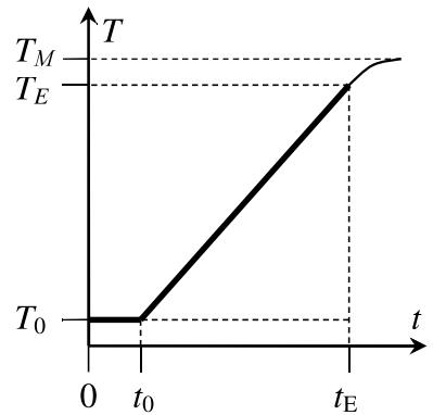
Затем процесс нагревания идет «как положено» с ростом температуры от времени. Если мы знаем начальную температуру  $T_0$  и время  $t_0$  и конечные их значения  $T_E$  и  $t_E$ , то можем записать уравнение теплового баланса, которое после необходимых преобразований сведётся к:
