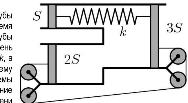
Рассмотрим начальное состояние системы до перерезания нити. Введем ось  $Ox$ , как показано на рисунке, все величины будем проектировать на эту ось. Найдем, под каким давлением  $P$  находится газ в трубе и какова деформация пружины  $\Delta l$ . Для этого запишем второй закон Ньютона для поршней  $S$  и  $2S$  (все силы, действующие на них, указаны на рисунке). Очевидно, что пружина в исходном состоянии сжата, ибо атмосферное давление больше, чем давление внутри трубы:
