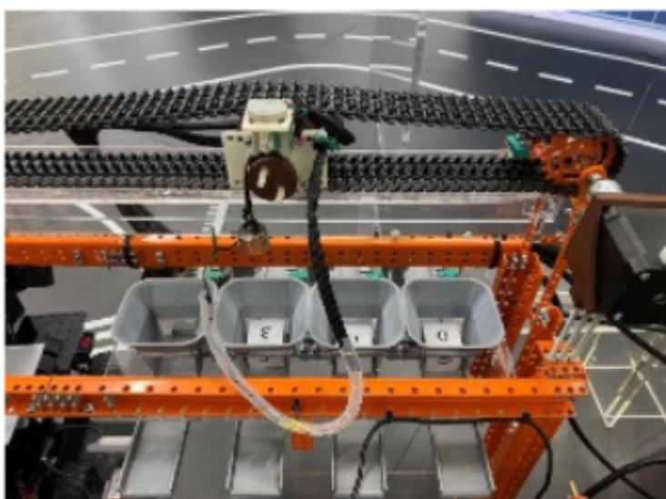
Рис. III.2.3: Каретка над вторым накопителем. Магнитный захват на верхнем уровне
