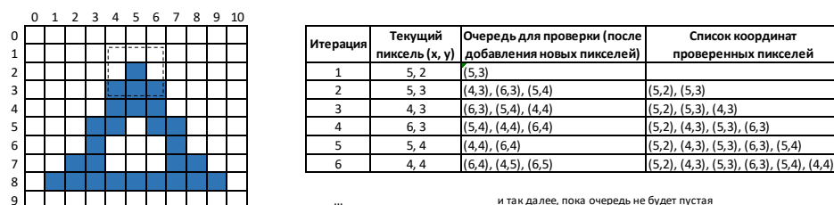
Рис. II.1.20: Пример сканирования пикселей фигуры по выбранному цвету
