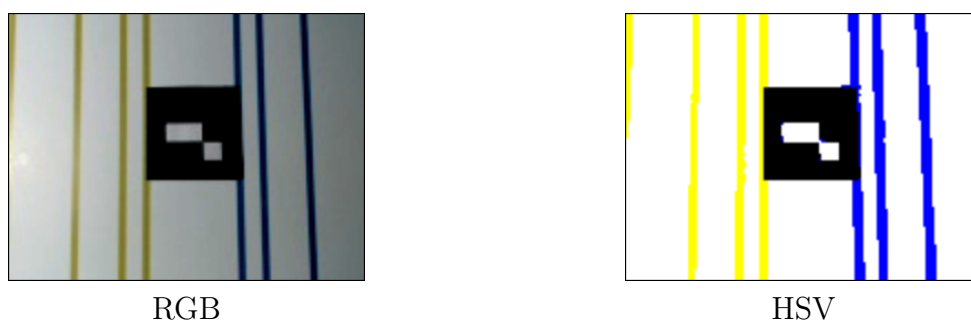
Рис. II.1.26: Обработанные изображения в форматах RGB и HSV-color
