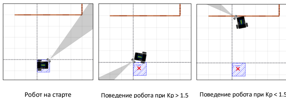
Рис. II.1.12: Положения робота при различных K_p
