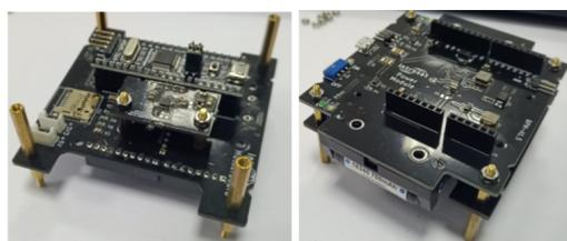
При необходимости подсоедините плату прототипирования соответствующим образом поверх платы питания. Затем вставьте стек плат в раму и прикрепите ее к верхней плате. Обязательно сначала вставьте платы в раму и только потом прикрепите ее к грани.
