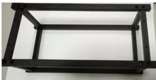
Рама собрана. Теперь необходимо закрепить электронику. Сборка «материнская плата + плата питания + плата прототипирования» крепится к верхней грани, а плата маховика — к нижней.
