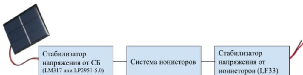
Для начала необходимо подсоединить солнечные батареи к стабилизатору, чтобы ограничить напряжение (до 5.5В) для зарядки ионисторов. На выбор предоставляется два стабилизатора: LM317 и LP2951. Плата с солнечными батареями содержит 4 солнечных элемента, соединенных последовательно.
