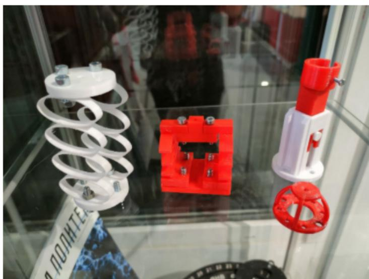
Участникам необходимо сделать проставку, срабатывающую как можно ближе к нагрузке в 50 Н. Срабатыванием считается защита робота от поломки при уведении фланца робота на высоту -10 см от рабочей плоскости. Данное уведение в целях безопасности имитируется приложением вертикальной нагрузки на проставку и измерением количества сжатия проставки с нагрузкой на фланец.
