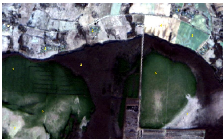
Изображение 2: красным цветом представлена интенсивность излучения в канале 6, зеленым — в канале 5, синим — в канале 4.
