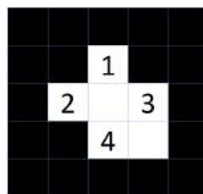
Рис. 9.7: Нумерация битов в маркера
