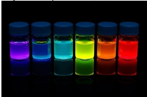
Рис. 1. Люминесценция (флуоресценция) взвесей наноразмерных частиц халькогенидов кадмия после облучения УФ-светом. В зависимости от своего размера частицы флуоресцируют разными цветами.
