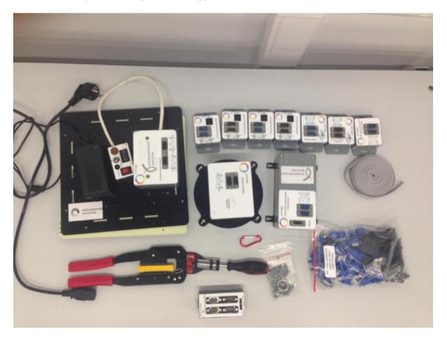
Набор для сборки спутника: система электропитания, бортовой компьютер, модуль маховика, 4 солнечных датчика, датчик угловой скорости, укв приемник, корпусные детали, набор крепежных винтов, шлейф кабельной сети, разъёмы, обжимной инструмент, тестер шлейфа, отвертка, адаптер питания.
