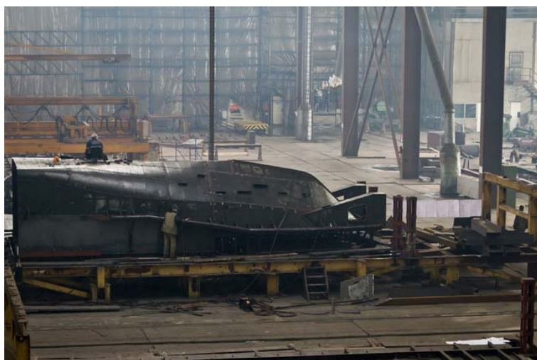
Сварка корпуса судна на судовой верфи
