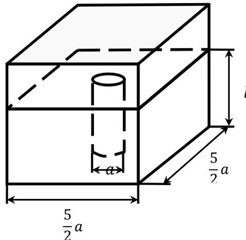
При погруженном стержне систему можно рассмотреть как параллельное соединение медного и ртутного проводников.
