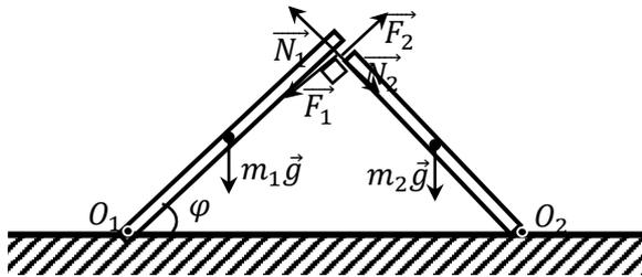
$F_1$  и  $F_2$  – силы трения, действующие на соответствующие стержни.
