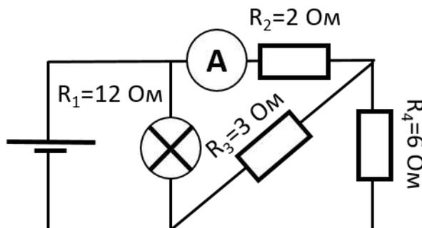
**9 класс, задача 8, 10 класс, задача 4, вариант 2** На схеме изображена электрическая цепь постоянного тока с подключенной лампочкой  $R_1$ , резисторами  $R_2$ ,  $R_3$ ,  $R_4$  и амперметром. Определите мощность, выделяемую на лампочке, если амперметр показывает ток в **4 А**. Ответ приведите в **ваттах**, округлив до ближайшего целого.
