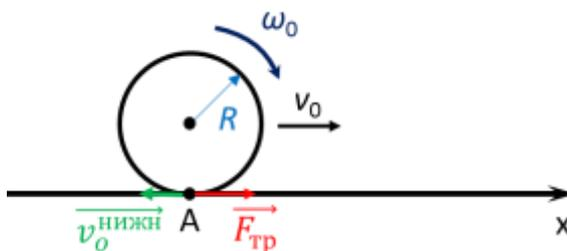
Сначала скорость поступательного движения колеса будет увеличиваться, колесо будет двигаться с проскальзыванием. Проскальзывание прекратится, когда суммарная скорость нижней точки обруча относительно земли будет равна нулю. Эта скорость складывается из скорости поступательного движения обруча и скорости из-за вращательного движения. Скорость поступательного движения направлена вправо, а вращение происходит по
