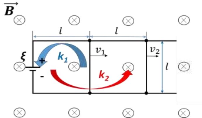
Каждая из перемычек, замыкающая рельсы, образует контур с дополнительной ЭДС индукции.
