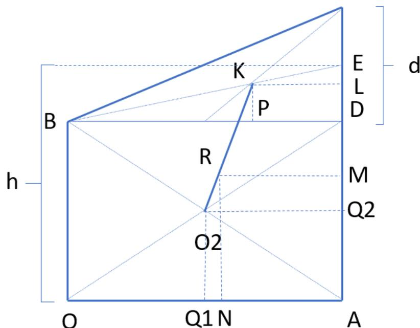
Центр масс воды обозначим точкой R. Чтобы найти плечи ON и NR, рассмотрим в плоскости XY прямоугольную трапецию: Центр тяжести прямоугольного треугольника находится в точке пересечения медиан. При этом медианы делятся точкой пересечения в отношении 2 к 1, считая от вершины. Введем обозначения  $OE = b$ ,  $CD = h$  и  $\operatorname{tg}\alpha = h/a$ . При этом для треугольника BCD:
