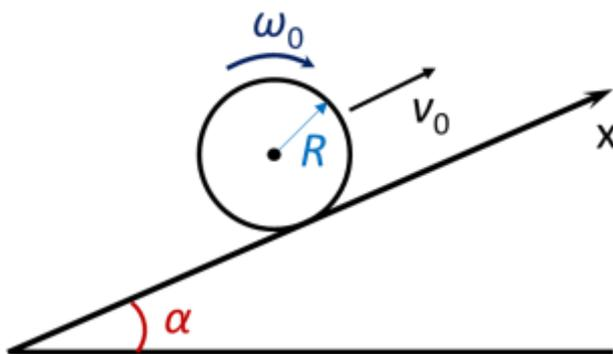
**Примечание:** Угловое ускорение  $\beta$  связано с моментом приложенных сил соотношением:  $I\beta = M$ , где  $I$  – момент инерции тела относительно оси вращения,  $M$  – момент внешних сил. Для обруча, вращающегося вокруг своей оси  $I = mR^2$ .
