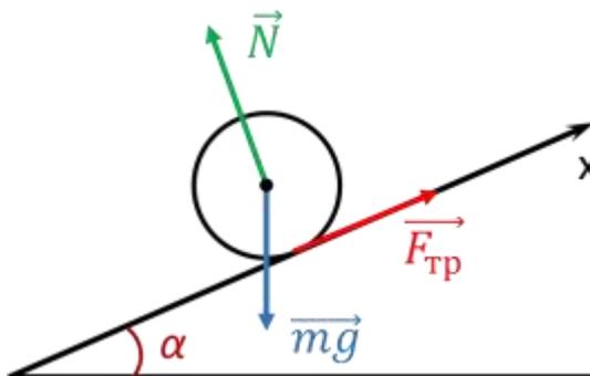
Проскальзывание прекратится, когда суммарная скорость нижней точки обруча относительно земли будет равна нулю. Эта скорость складывается из скорости поступательного движения обруча и скорости из-за вращательного движения. Скорость поступательного движения направлена вправо, а вращение происходит по часовой
