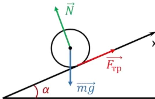
Проскальзывание прекратится, когда суммарная скорость нижней точки обруча относительно земли будет равна нулю. Эта скорость складывается из скорости поступательного движения обруча и скорости из-за вращательного движения. Скорость поступательного движения направлена вправо, а вращение происходит по часовой стрелке, следовательно для прекращения проскальзывания модули скорости и  $\omega R$  должны
