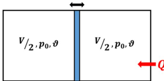
**Примечание:** процесс в теплоизолированной системе описывается уравнением адиабаты  $pV^\gamma = \text{const}$ , где  $p$  – давление газа,  $V$  – объем,  $\gamma = C_p/C_v$  – показатель адиабаты ( $C_p$  и  $C_v$  – теплоемкости газа соответственно при постоянном давлении и объеме). Для одноатомного газа  $\gamma = 5/3$ .
