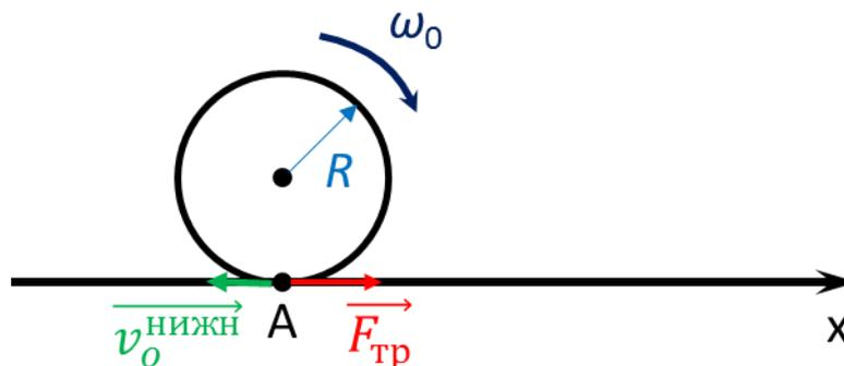
Сначала скорость поступательного движения колеса будет увеличиваться, колесо будет двигаться с проскальзыванием. Это будет происходить до тех пор, пока  $v(t) < \omega(t)R$ . Поступательное движение обруча на этом этапе можно рассматривать как равноускоренное, то есть координата его центра будет меняться по закону
