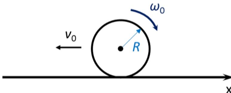
**Примечание:** Угловое ускорение  $\beta$  связано с моментом приложенных сил соотношением:  $I\beta = M$ , где  $I$  – момент инерции тела относительно оси вращения,  $M$  – момент внешних сил. Для обруча, вращающегося вокруг своей оси  $I = mR^2$ .
