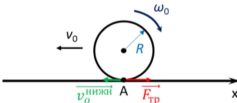
Сначала колесо будет двигаться с проскальзыванием. Проскальзывание прекратится, когда суммарная скорость нижней точки обруча относительно земли будет равна нулю.
