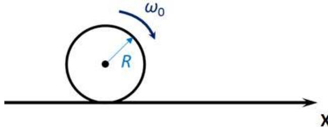
**Примечание:** Угловое ускорение  $\beta$  связано с моментом приложенных сил соотношением:  $I\beta = M$ , где  $I$  – момент инерции тела относительно оси вращения,  $M$  – момент внешних сил. Для обруча, вращающегося вокруг своей оси  $I = mR^2$ .
