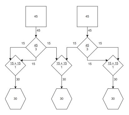
Если пропускная способность сетевого соединения равна 60 Мбит/с, то одна из схем сети может выглядеть как изображено на рисунке слева. Но данная схема не является минимальным ответом.
