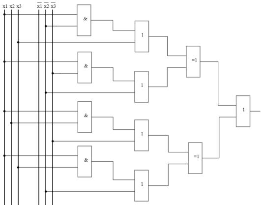
Найдите такую комбинацию значений логических переменных x1, x2 и x3, при которой на выходе будет получаться значение «ложь». В ответе укажите подряд три значения 0 или 1, соответствующие значениям логических переменных в порядке возрастания их индексов, где 0 означает ложное значение, а 1 – истинное значение. Если таких комбинаций несколько, укажите любую из них. Если таких комбинаций нет, укажите в ответе NULL. Пример записи ответа: 010.
