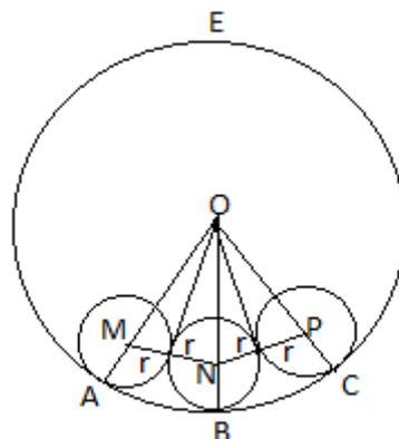
Положение колеса  $A$  - встреча с препятствием  $B$ , положение  $C$  - конец преодоления препятствия,  $\angle AOC = 4\varphi$ , где  $\sin \varphi = \frac{r}{R-r}$ . Путь, пройденный центром колеса во время преодоления
