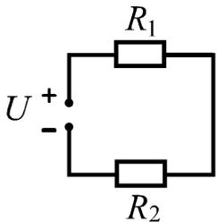
**Ф10.4-1** Как изменится сила тока в резисторах  $R_1$  и  $R_2$ , если подаваемое напряжение  $U$  увеличить в  $n = 2$  раза, а сопротивление  $R_2$  уменьшить в  $m = 3$  раза? Сопротивление резисторов  $R_1 = R$ ,  $R_2 = 6R$ , напряжение  $U = 2$  В.
