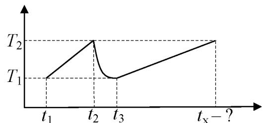
Величины  $T_1$ ,  $T_2$ ,  $t_1$ ,  $t_2$ ,  $t_3$  заданы. Удельная теплоемкость воды  $c$ , удельная теплота плавления снега  $\lambda$ . Мощность электроплитки постоянна, теплообменом с окружающей средой пренебречь.
