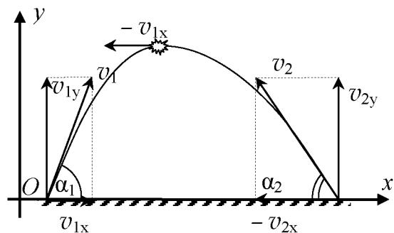
Учитывая также, что скорости в момент столкновения были горизонтальны, запишем закон сохранения импульса для двух тел до и после столкновения в проекции на горизонтальную ось:
