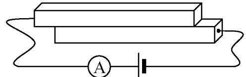
сопротивлением) батареи через амперметр. Вначале края стержней совпадают (стержни соприкасаются по всей длине) и амперметр показывает  $I_1 = 6$  А. Стержни начинают раздвигать вдоль длинной стороны так, что они остаются плотно прижатыми друг к другу (см. рис.). Когда длина соприкасающейся части уменьшилась до  $2/3$  длины стержня, показание амперметра уменьшилось до  $I_2 = 4,5$  А. Сколько покажет амперметр, когда длина соприкасающейся части уменьшится до половины длины стержня?
