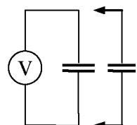
конденсатор отсоединили от схемы, полностью разрядили и опять присоединили параллельно к схеме. Какое напряжение при этом покажет вольтметр?
