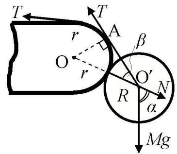
Пусть угол между  $\vec{N}$  и  $m\vec{g}$  равен  $\alpha$ , а угол между  $\vec{N}$  и  $\vec{T}$  —  $\beta$ . Поскольку шар вытягивают медленно, то шар в каждый момент времени находится в равновесии, поэтому сумма сил, действующих на него равна 0.
