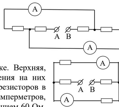
30 Ом, протекает ток 2 А. Ток в средней ветви равен сумме токов в верхней и нижней ветвях, т.е. составляет 3 А. При этом на резисторах 30 и 60 Ом в средней ветви падают напряжения 90 и 180 В соответственно, т.е. в сумме 270 В. Напряжение источника находим как  $270 + 60 = 330$  В.
