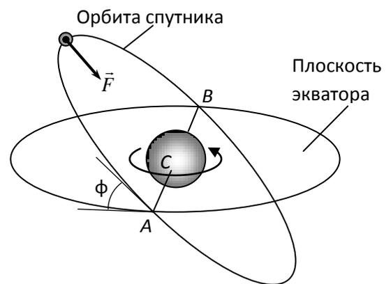
На спутник на орбите действует сила тяготения  $\vec{F}$ , модуль которой  $F = G \frac{Mm}{R^2}$ , где  $M$  – масса планеты,  $m$  – масса спутника. Эта сила вызывает центростремительное ускорение
