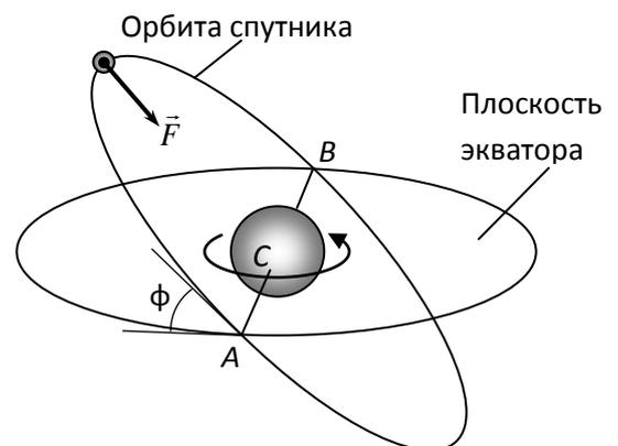
плоскости экватора. Спутник переходит из точки  $A$  в точку  $B$  за половину периода  $T_{\text{обращ}}$  обращения спутника вокруг планеты. За это время точка  $C$  на поверхности планеты, лежащая на диаметре  $AB$ , должна оказаться на его противоположной половине. Для этого нужно время, равное  $\frac{1}{2}T, \frac{3}{2}T, \frac{5}{2}T$  и т. д., то есть  $\tau = \left(n + \frac{1}{2}\right)T$ . Отсюда  $T_{\text{обращ}} = (2n + 1)T$ , где  $n = 0, 1, 2, \dots$ .
