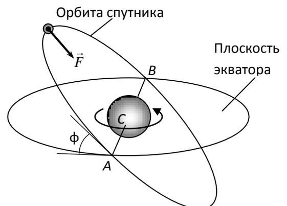
на его противоположной половине. Для этого нужно время, равное  $\frac{1}{2}T, \frac{3}{2}T, \frac{5}{2}T$  и т. д., то есть  $\tau = \left(n + \frac{1}{2}\right)T$ . Отсюда  $T_{\text{обращ}} = (2n + 1)T$ , где  $n = 0, 1, 2, \dots$ . (1)
