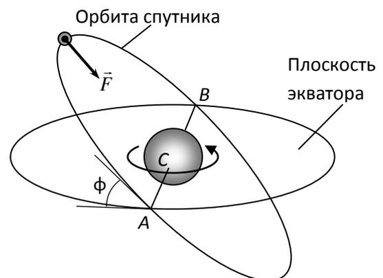
обращения спутника вокруг планеты. За это время точка  $C$  на поверхности планеты, лежащая на диаметре  $AB$ , должна оказаться на его противоположной половине. Для этого нужно время, равное  $\frac{1}{2}T, \frac{3}{2}T, \frac{5}{2}T$  и т. д., то есть  $\tau = \left(n + \frac{1}{2}\right)T$ . Отсюда  $T_{\text{обращ}} = (2n + 1)T$ , где  $n = 0, 1, 2, \dots$ .
