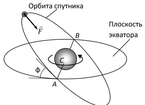
На спутник на орбите действует сила тяготения  $\vec{F}$ , модуль которой  $F = G \frac{Mm}{R^2}$ , где  $M$  – масса планеты,  $m$  – масса спутника. Эта сила вызывает центростремительное ускорение спутника:  $G \frac{Mm}{R^2} = \frac{mv^2}{R}$ . Из этого равенства получаем скорость спутника на орбите
