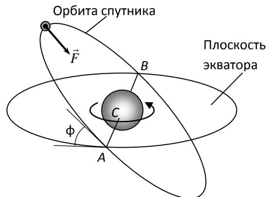
уравнение (1), получим:  $T_{\text{обращ}} = 2\pi\sqrt{\frac{R^3}{GM}} = (2n+1)T$ . Отсюда видно, что минимальный радиус орбиты спутника соответствует случаю  $n = 0$ . Для радиуса этой орбиты получаем:
