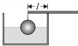
**Решение.** На шарик действует сила тяжести  $mg$ , архимедова сила  $F_A = \frac{1}{2}\rho Vg$  и сила натяжения нити  $T$ . Поскольку шарик находится в равновесии, то  $T = mg - \frac{1}{2}\rho Vg$ . Сила тяжести  $Mg$ , действующая на стержень, приложена к середине стержня. Используя правило моментов, запишем условие равновесия стержня:  $Mg\left(\frac{L}{2} - l\right) = Tl$ . Из записанных равенств находим, что
