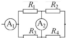
силы тока, текущего через амперметр  $A_1$ , к силе тока, текущего через амперметр  $A_2$ , равно  $n =$ . Определите сопротивление резистора  $R_1$ , если сопротивления остальных резисторов равны:  $R_2 = 2 \text{ кОм}$ ,  $R_3 = 3 \text{ кОм}$ ,  $R_4 = 4 \text{ кОм}$ . Ответ приведите в килоомах, округлив до двух знаков после запятой.
