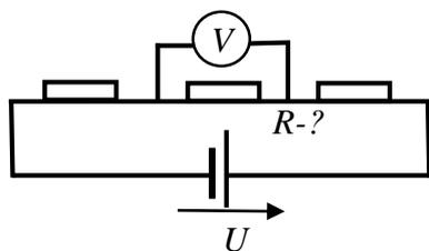
4. Изображенная на рисунке цепь содержит гальванический элемент, создающий независимо от тока напряжение  $U$ , и три резистора. Включенный параллельно среднему резистору идеальный вольтметр показывает напряжение  $V$ . Если его заменить на идеальный амперметр, то последний будет показывать ток  $J$ . Определите сопротивление среднего резистора.
