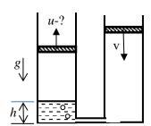
**2.** Пневматический подъемник содержит два вертикально стоящих цилиндра. Ведомый цилиндр имеет сечение S и закрыт подвижным поршнем массы M. Ведущий цилиндр сечением  $S_1$  также закрыт подвижным поршнем. Внизу цилиндры связаны трубкой. В ведомом цилиндре оборудован сифон: он до уровня h заполнен жидкостью, в которую через подведенную вблизи дна трубку поступает воздух из ведущего цилиндра (см. рисунок). С какой скоростью будет подниматься поршень в ведомом цилиндре, если
