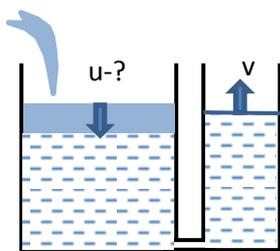
5. Два цилиндра сечением  $S_1$  и  $S_2$ ,  $S_1 / S_2 = 2$ , внизу соединены тонкой трубкой. В цилиндрах находится жидкость плотности  $\rho_0 = 1000 \text{ кг/м}^3$ . В первый цилиндр (сечением  $S_1$ ) начинают медленно наливать жидкость плотности  $\rho = 800 \text{ кг/м}^3$ . Во втором цилиндре поверхность жидкости поднимается со скоростью  $v = 1 \text{ см/с}$ . С какой скоростью поднимается уровень жидкости в первом цилиндре? Скорость определите в сантиметрах в секунду.
