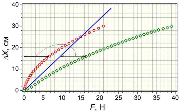
При *параллельном* соединении пружин одинаковой исходной длины обе пружины растягиваются на одинаковую величину (+ 1 балл). Силы, которые требуется приложить к их концам для таких растяжений, будут по величине равны сумме сил, которые растягивают каждую из пружин (+ 2 балла, если это условие корректно использовано при решении).
