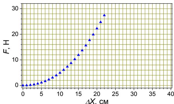
*Решение:* На таком же графике изобразим зависимость величины сил, которые растягивают пружину с жесткостью 110 Н/м = 1.1 Н/см, от величины растяжения (красная прямая, + 3 балла за построение такого графика или корректный учет деформации такой пружины при вычислениях). При последовательном соединении пружин обе пружины
