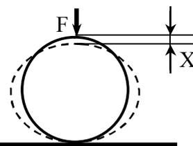
Решением является фотография установки, график, на котором точками отмечены результаты измерений  $X(F)$  для не менее чем 5-ти независимых измерений величины деформации трубы для каждого из использованных размеров. Кроме этого, надо привести среднее значение коэффициента жесткости для каждой трубы, если измерения покажут, что это понятие имеет смысл использовать.
