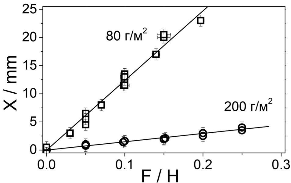
Величина деформации в исследованном диапазоне нагрузок оказывается примерно пропорциональной величине приложенной силы. Таким образом, можно ввести независящий от нагрузки коэффициент упругости или жесткость цилиндра, который связывает величину приложенной силы и деформацию тела:  $F=kX$ .
