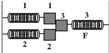
2. Пружины жёсткостей  $k_1, k_2, k_3$  прикреплены к стенкам и трём грузам (см. рис. вид сверху). Грузы находятся на горизонтальной плоскости в состоянии покоя. Первый и второй грузы склеены с третьим, упругая сила со стороны третьей пружины  $F$ . Длины первой и второй пружин в недеформированном состоянии одинаковы. В некоторый момент склейка разрушилась. Найдите наибольшие кинетические энергии грузов при возникших колебаниях. Трения нет.
