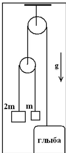
3. Грузы масс  $2m$  и  $m$  связаны нитью, проходящей через подвижный блок. Он связан с очень тяжёлой глыбой нитью, проходящей через второй неподвижный блок. Глыбу отпускают. Найти ускорения грузов. Нити нерастяжимы и невесомы, трением пренебречь. Ускорение свободного падения  $g$ .
