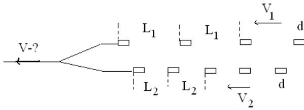
1. Автомобили длины  $d = 5$  м движутся со скоростью  $v_1 = 90$  км/час с интервалом  $L_1 = 30$  м в первом ряду и со скоростью  $v_2 = 60$  км/час и с интервалом  $L_2 = 10$  м во втором (см. рис.). На некотором участке они перестраиваются в общий ряд. С какой наименьшей одинаковой для всех скоростью они могут двигаться в общем ряду?
