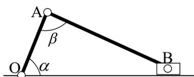
6. Кривошипно-шатунный механизм состоит из кривошипа ОА (стержня, прикрепленного к шарниру О), шатуна АВ (стержня, шарнирно прикрепленного к кривошипу в точке А) и ползуна В (точечной детали, способной перемещаться вдоль поверхности и шарнирно
