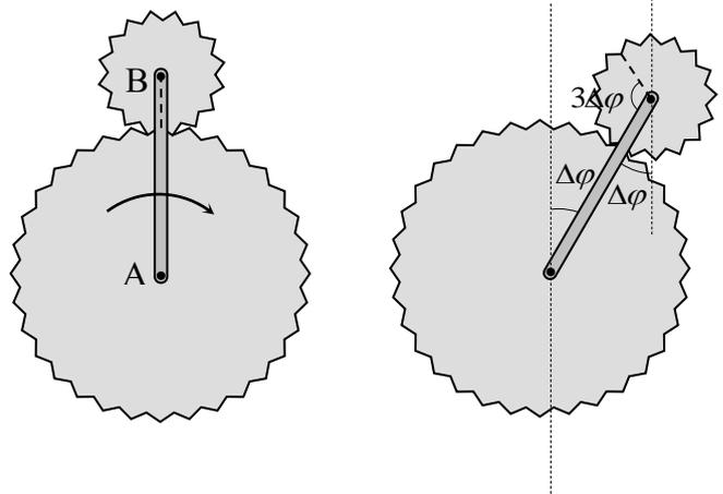
вому положению точки касания (см. рисунок; соответствующий радиус малого колеса показан на рисунке пунктиром). А поскольку сама точка касания повернется на угол  $\Delta\varphi$ , то поворот малого колеса составит угол  $4\Delta\varphi$ .
