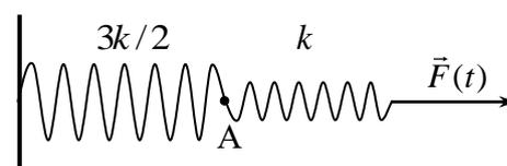
зависящую от времени силу так, что этот конец движется с постоянной скоростью  $v$  (см. рисунок). Найти скорость точки соединения пружин (точка А на рисунке) и внешнюю силу  $F(t)$  как функцию времени, обеспечивающую данное движение пружин. Массой пружин пренебречь.
