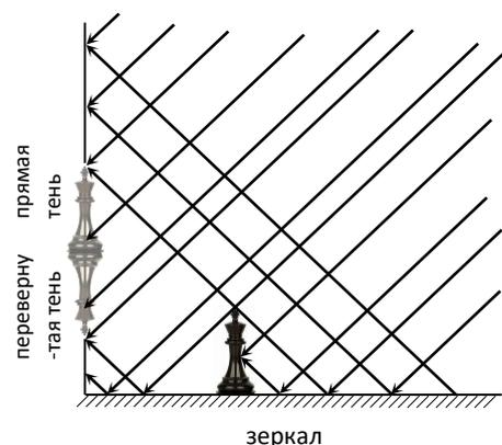
(см. рисунок). И поскольку все падающие лучи параллельны друг другу, то и отраженные от плоского зеркала лучи параллельны друг другу. Поэтому размеры областей тени (и прямой и перевернутой) будут равны размерам фигуры.
