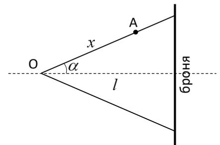
Пусть высота выемки равна  $l$ , угол при ее вершине  $2\alpha$  (см. рисунок; отмечен угол, равный половине угла при вершине выемки). Рассмотрим точку выемки А, лежащую на расстоянии  $x$  от ее вершины. Волна детонации дойдет от точки О (где детонация начинается) до точки А за время  $x/5v$ , а продукты взрыва в точке А долетят до брони за время  $(l - x \cos \alpha)/v$ . Поэтому продукты взрыва в точке А достигнут брони через время
