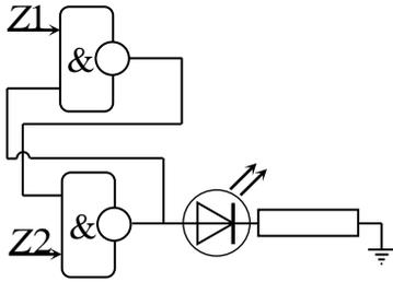
могут быть поданы либо напряжение питания – несколько вольт (логическая единица:  $X1, X2 = 1$ ), или нулевое напряжение (логический ноль:  $X1, X2 = 0$ ). Напряжение на выходе
